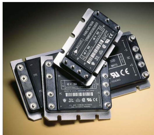
图 1. 有多种尺寸、输入、输出电压功率选择的 DC-DC 转换器，满足多种电源需求。图中所示是全砖、半砖及 1/4 砖 DC-DC 转换器，常用输入电压是 12、24、28、36、48、50、72、150、270、300 及 375Vdc (表 1)，只有少数供应商能提供这样阔的选择！典型输出电压有 1.8、2、2.5、3.3、5、12、15、24、28 及 48Vdc (表 2)，大部份 DC-DC 模块都可微调输出电压，有些模块的可调范围是额定值的 -90% 至 +10%。
